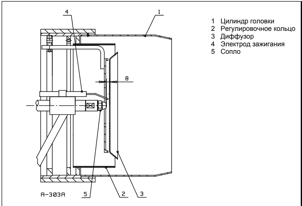
Размер 8 мм в рисунке означает расстояние сопла от задней поверхности диффузора.
