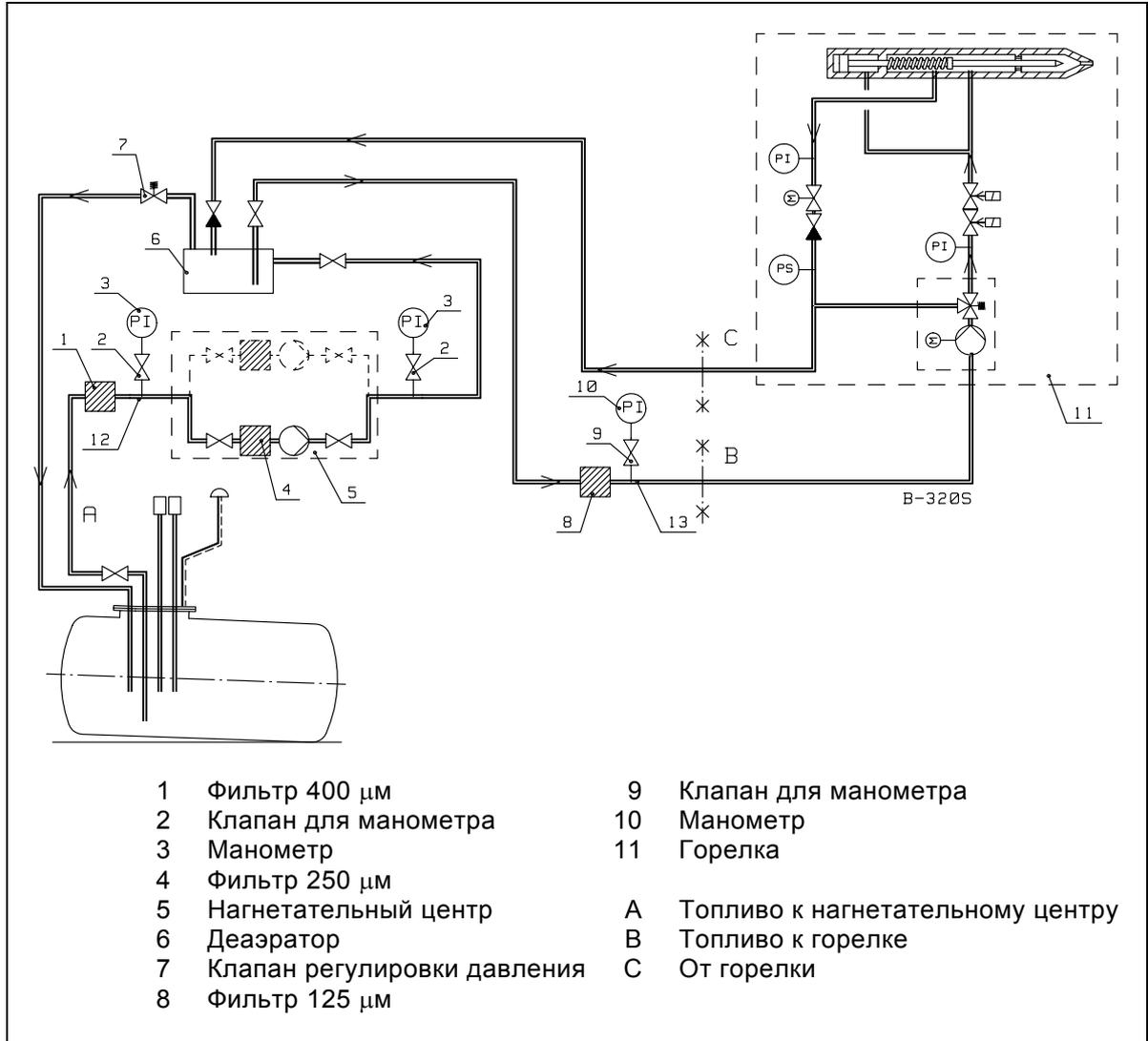
Производительность насосной станции должна быть на 200 кг/ч выше сжигаемого количества топлива. Например, при производительности горелки 600 кг/ч ⇒ требуемая производительность насосной станции ок. 800 кг/ч.
