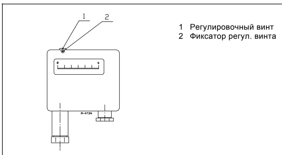
Реле давления топлива (макс.) контролирует давление топлива в возвратной трубе. Если давление превышает заданное значение (заводская установка 6 бар), горелка останавливается.
